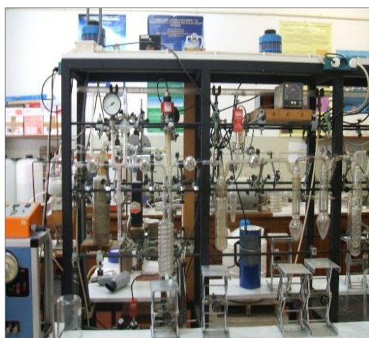
Linha de síntese de benzeno para datação por 14 C
