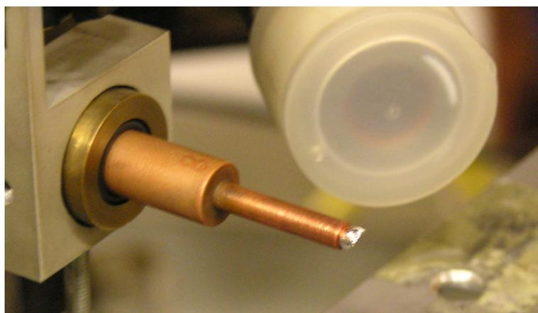
Fig. 2b – Detalhe da ponteira de extracção de feixe com corte a 45º para quantificação de carga pelo rendimento de raios-X.
