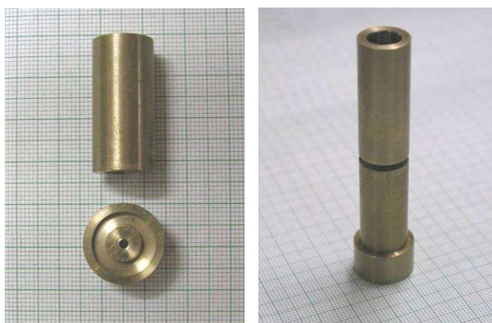
Figuras 7 e 8: Sistema de montagem das janelas de \text{Si}_3\text{N}_4 na ponteira.
