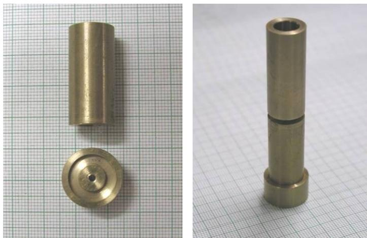
Figuras 7 e 8: Sistema de montagem das janelas de  $\text{Si}_3\text{N}_4$  na ponteira.
