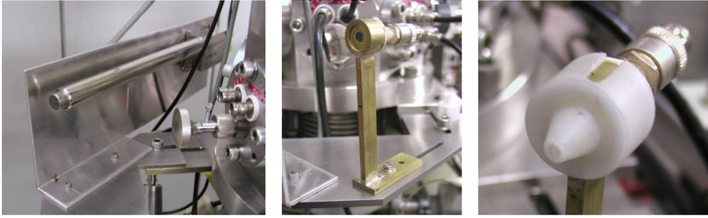
Figuras 9, 10 e 11: suportes para os detectores de raios-X e partículas e campânula de ejeção de He para o detector de partículas.
