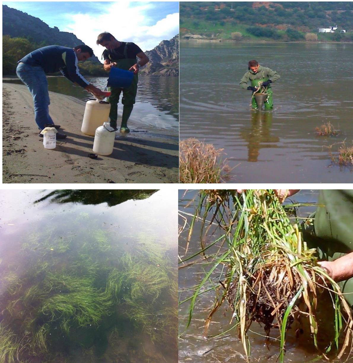
Figura I.9- Colheita de amostras de água, sedimentos e plantas aquáticas no Rio Tejo.
