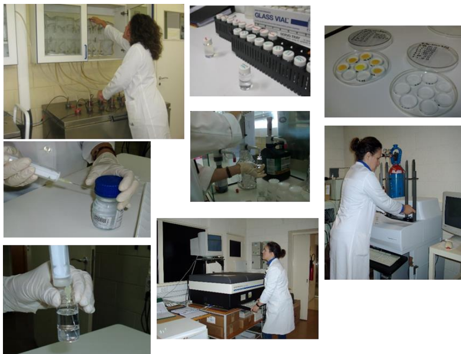
Figura I.13- Preparação e medição de amostras de água para consumo humano para a determinação da concentração de atividade alfa/beta e dos radionuclídeos ^3\text{H} , ^{90}\text{Sr} e ^{222}\text{Rn} .
