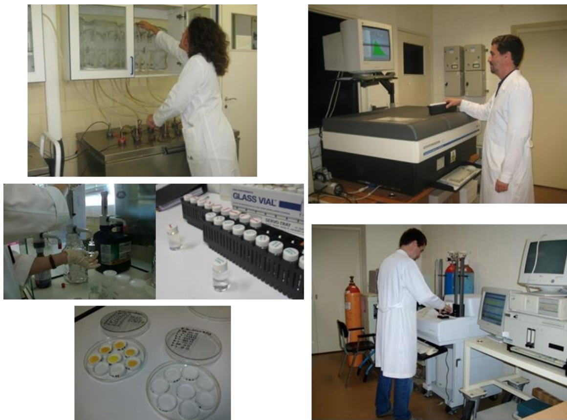
Figura I.14- Preparação e medição de amostras de água para consumo humano para a determinação da concentração em atividade em radionuclídeos emissores alfa/beta e beta.
