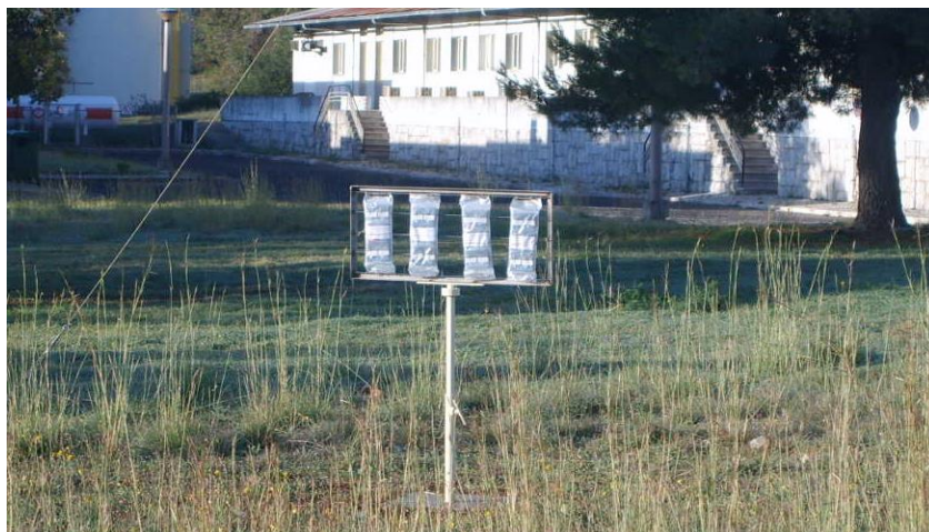
Figura II.5 – Dosímetros ambientais expostos no ponto de medida PPR1.
