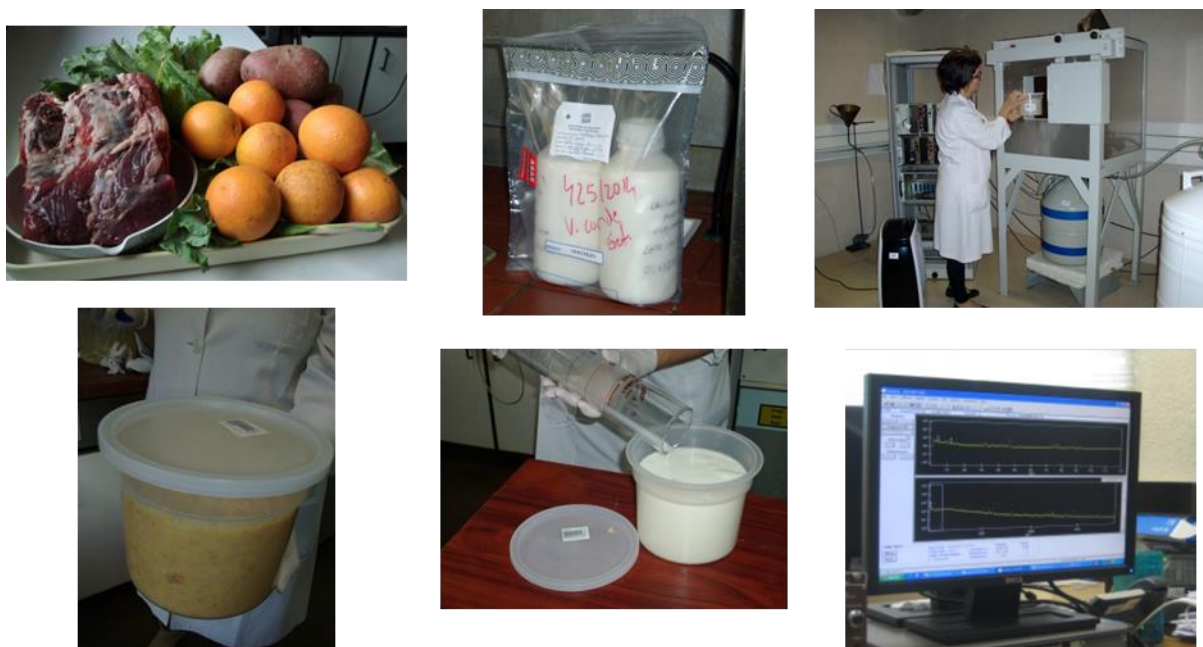
Figura I.14- Preparação de amostras de produtos alimentares e medição por espectrometria gama
