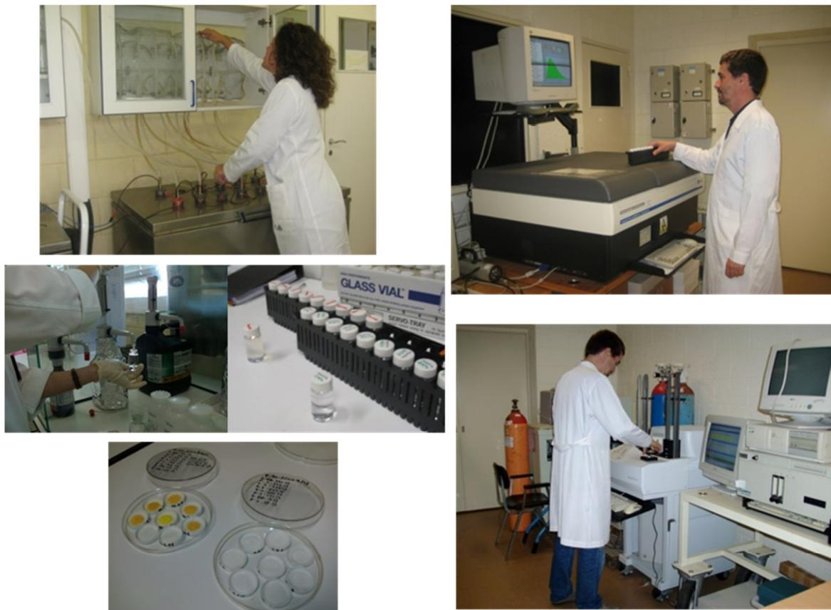
**Figura I.13- Preparação e medição de amostras de água para consumo humano para a determinação da concentração de atividade em radionuclídeos emissores alfa/beta e beta.**
