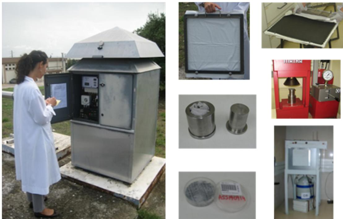
**Figura I.5- Estação de amostragem contínua de aerossóis (tipo ASS-500) recolha e preparação dos filtros para medição por espectrometria gama**
