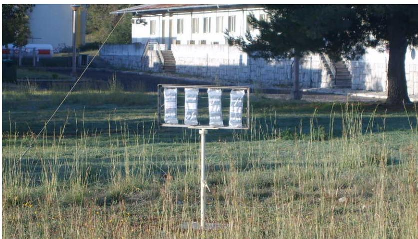
**Figura II.4 – Dosímetros ambientais expostos no ponto de medida Anemómetro.**
