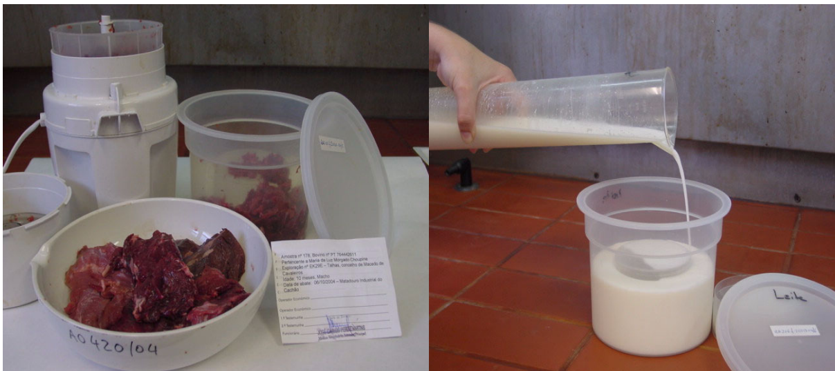
Figura 8- Preparação de amostras de alimentos para medida por espectrometria gama
