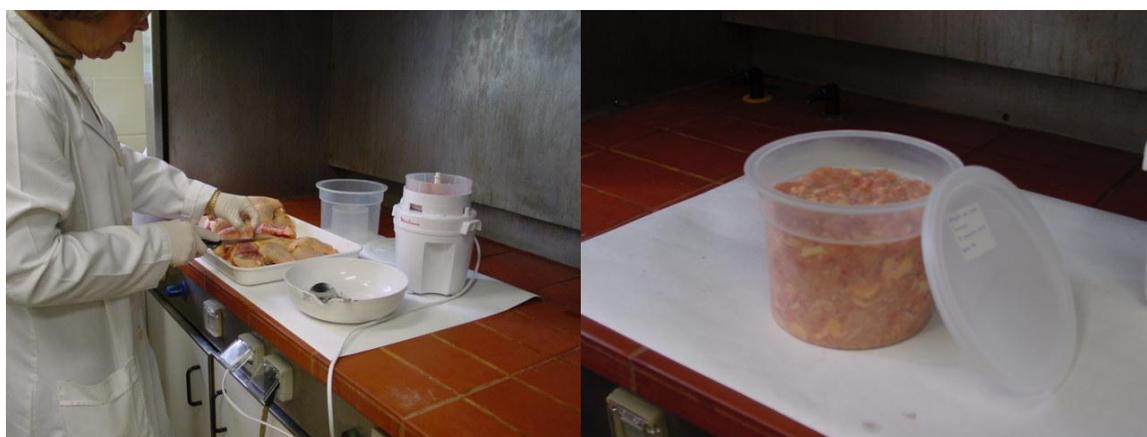
Figura 13- Preparação de amostras de alimentos para medida por espectrometria gama
