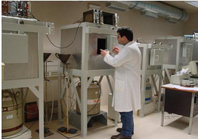
Figura 14- Sala de detectores de GeHp usados para espectrometria gama
