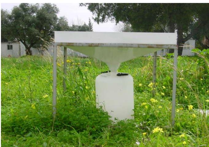
Figura 12- Dispositivo de amostragem de água da chuva localizado no *campus* de Sacavém do ITN
