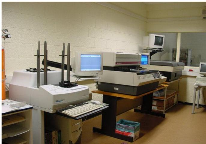
Figura 15- Sala de sistemas de contagem beta de baixo fundo e de espectrômetros de cintilação líquida
