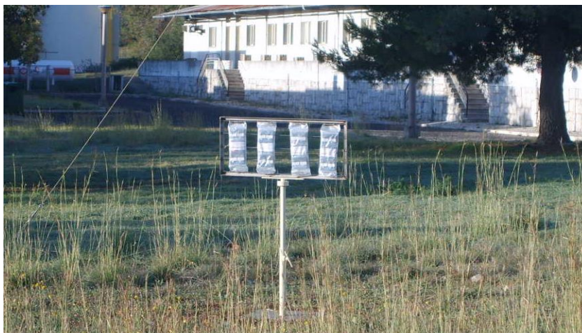
Figura II.5 – Dosímetros ambientais expostos no ponto de medida PRR1.
