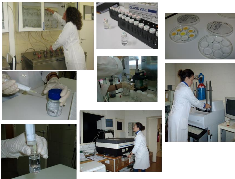
Figura I.12- Preparação e medição de amostras de água para consumo humano para a determinação da concentração de atividade alfa/beta e dos radionuclídeos ^3\text{H} , ^{90}\text{Sr} e ^{222}\text{Rn} .
