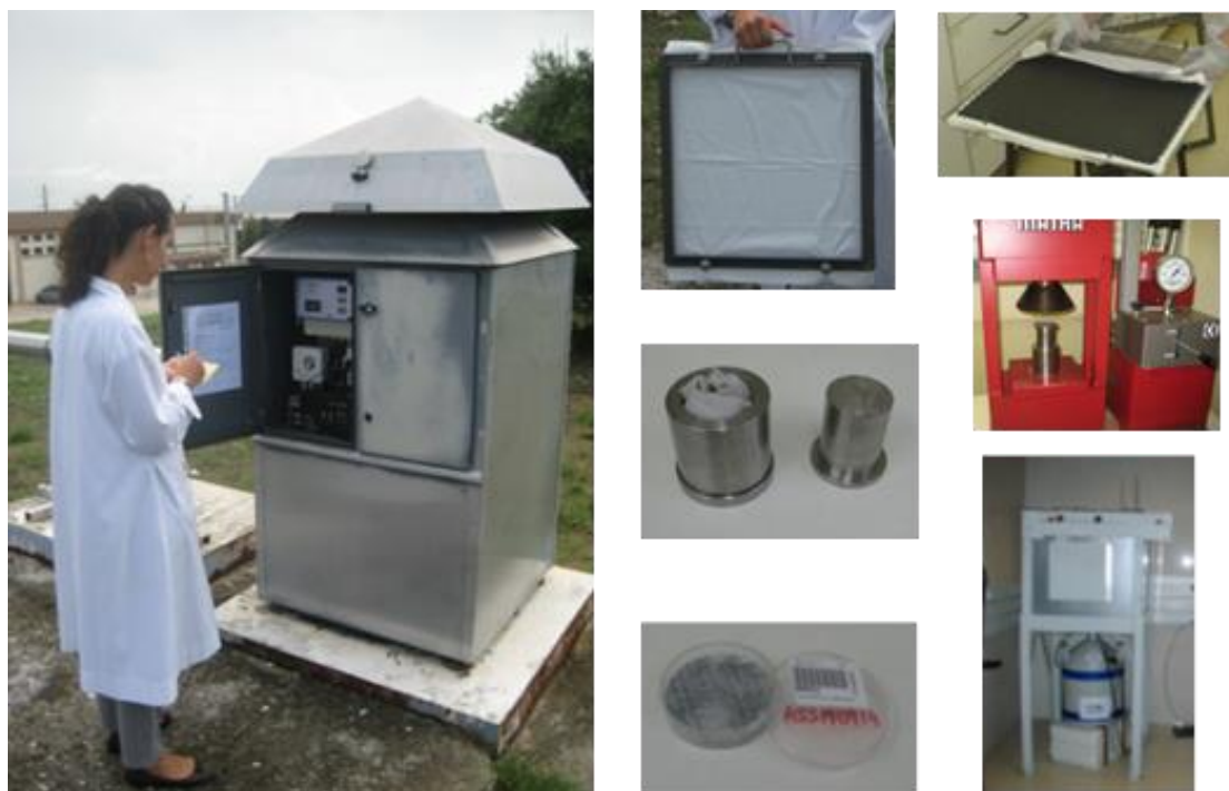
Figura I.5- Estação de amostragem contínua de aerossóis (tipo ASS-500) recolha e preparação dos filtros para medição por espectrometria gama (CTN, Sacavém).
