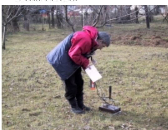
4. Monitorização de radioactividade com detector alfa (Kosovo).
