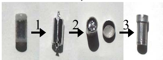
Fig. 1 Cadmium container used in ENAA.
